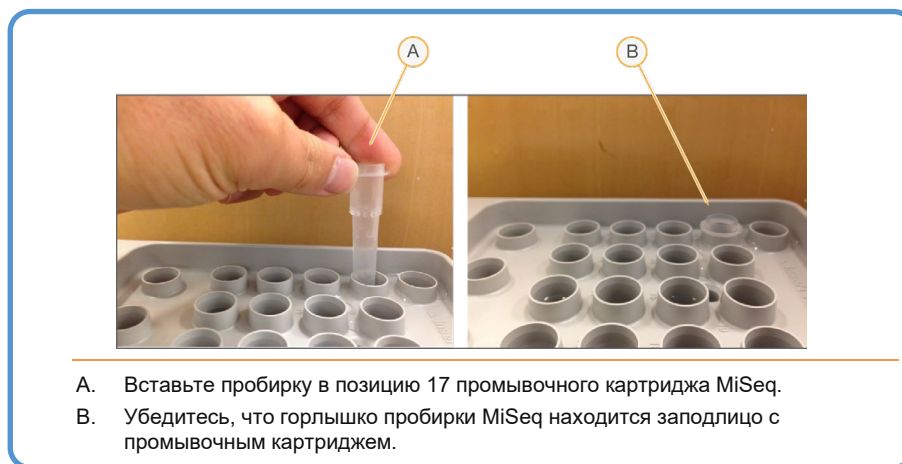
Рисунок 5. Вставка трубки для промывки 0,01% гипохлоритом натрия в лоток для промывки.
